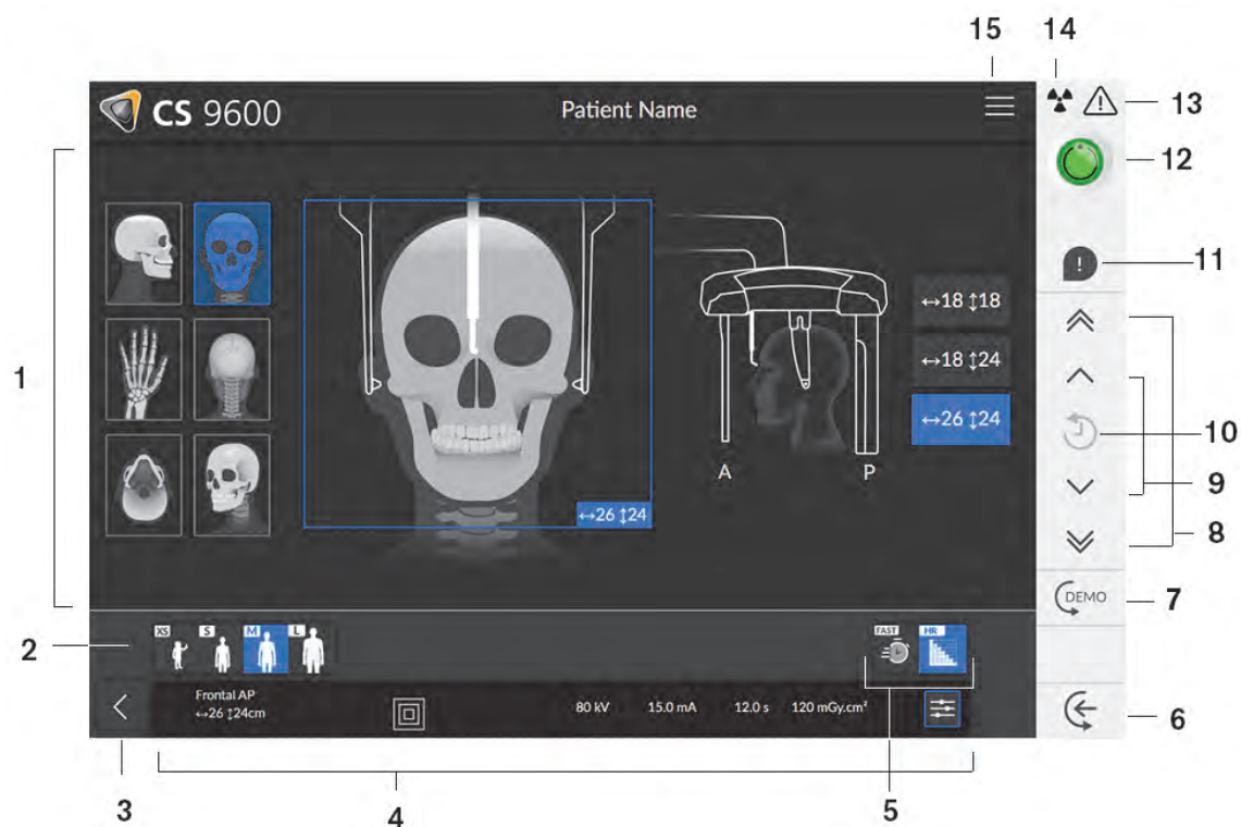
Figura 3 Panel de control táctil del sistema CS 9600 cefalométrico
